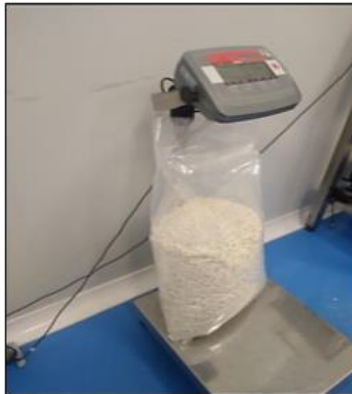
Figure 28 : La pesée des gélules remplis 8 Kg
