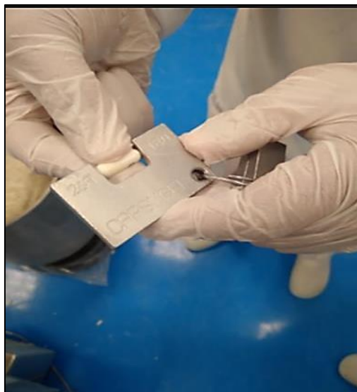
Figure 29 : Mesure la taille des gélules gabarit de taille 2
